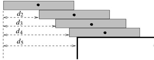
Bild 8.1: Auflegen der Bauklötze.
