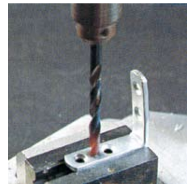
3 pav. Grąžtui sukantis jo kinetinė energija virsta vidine energija.
