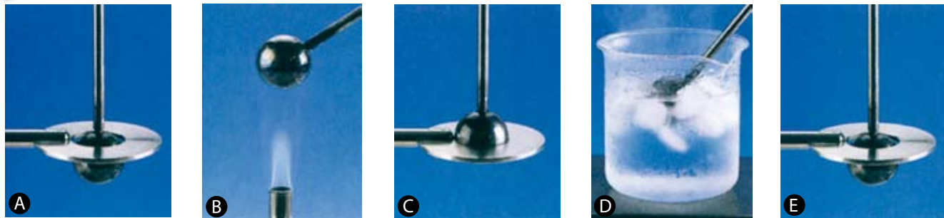
1 pav. Kietųjų kūnų šiluminį plėtimąsi įrodantis bandymas.
