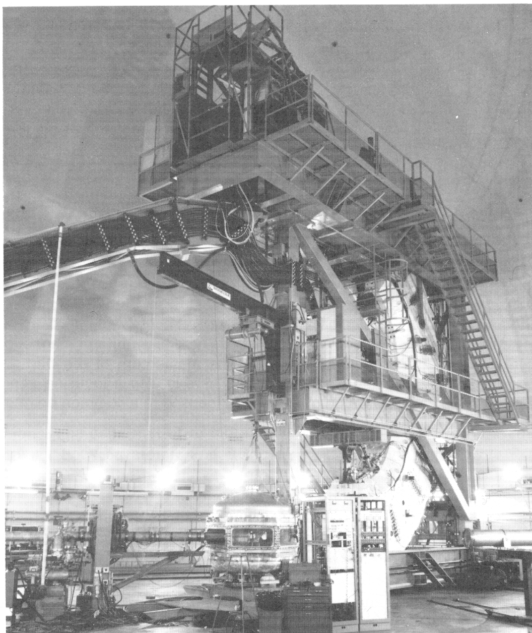
10.6 pav. Didelės skiriamosios gebos protonų spektrometras (Los Alamos Nacionalinė Laboratorija, JAV). Protonai patenka į spektrometrą iš kairės vamzdžiu, kuris yra apačioje, paskui yra išsklaidomi, pereina du kreiptuvus ( 75^\circ ) ir detektuojami viršuje. Kai protonų energija yra 800 MeV, energinė skyra yra maždaug 30 keV.
