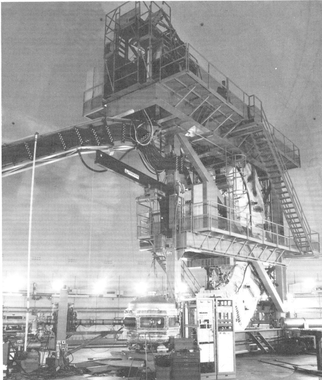
10.6 pav. Didelės skiriamosios gebos protonų spektrometras (Los Alamos Nacionalinė Laboratorija, JAV). Protonai patenka į spektrometrą iš kairės vamzdžiu, kuris yra apačioje, paskui yra išsklaidomi, pereina du kreiptuvus (75°) ir detektuojami viršuje. Kai protonų energija yra 800 MeV, energinė skyra yra maždaug 30 keV
