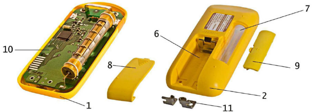
A.2 paveikslas – Galinis dozimetro „Terra-P“ vaizdas su nuimtu dangteliu
