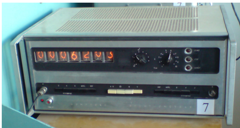
5 pav. Detektoriaus impulsų skaičiavimo įrenginys
