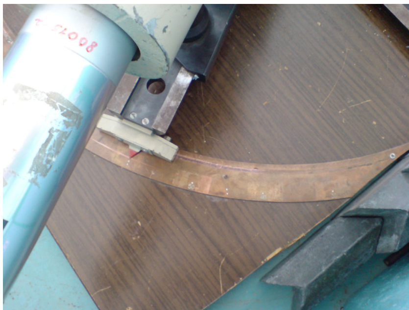
4 pav. Varinė juosta, ant kurios atidėti sklaidos kampai. Padalos (balti taškai) yra kas 10^\circ . Sklaidos kampas nustatomas pagal raudoną rodyklę. Šiame pavyzdyje sklaidos kampas yra 60^\circ
