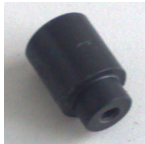
10 pav. Universalusis radioaktyviųjų šaltinių laikiklis (nufotografuotas iš tos pusės, iš kurios jis užsukamas ant slankiojo strypo)
