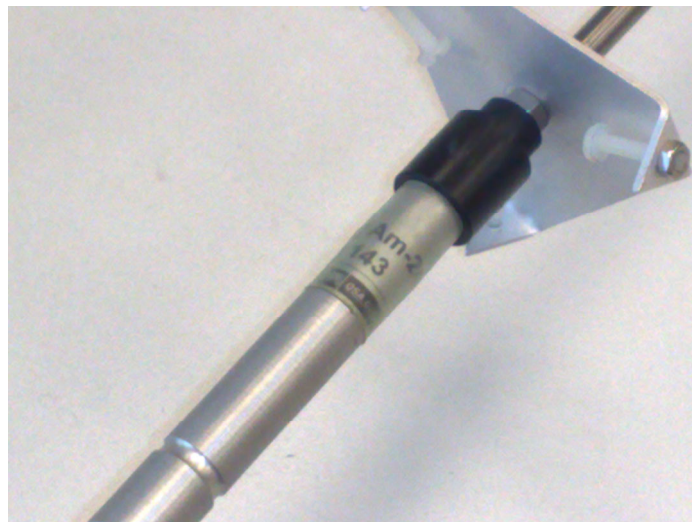
12 pav. Radioaktyviojo šaltinio pritvirtinimas prie universaliojo radioaktyviųjų šaltinių laikiklio
