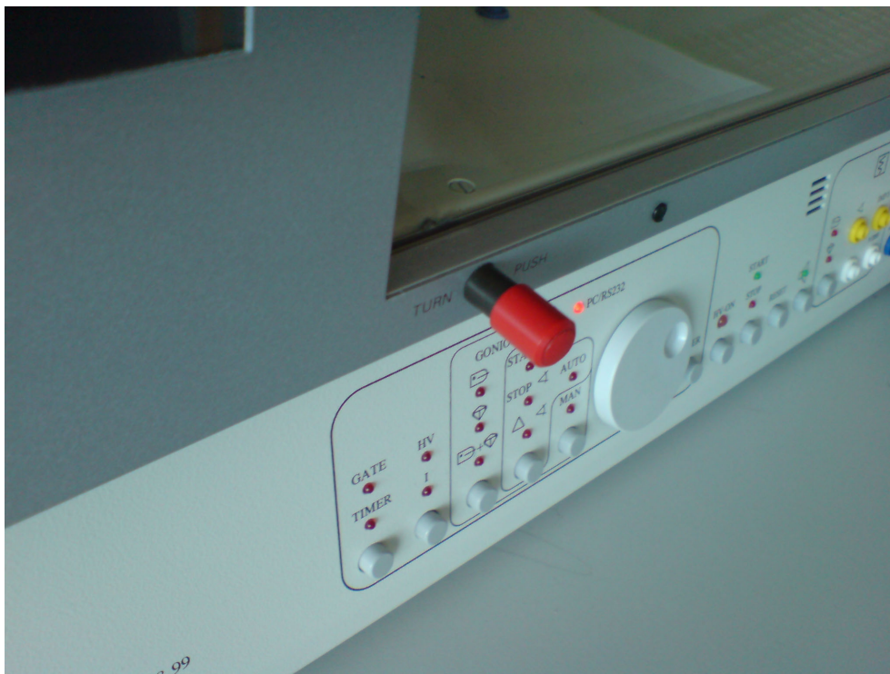
4 pav. Rentgeno aparato durelių fiksatorius (šioje nuotraukoje durelės užfiksuotos uždarytoje padėtyje)
