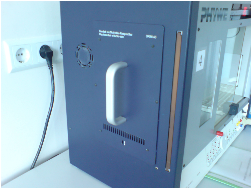
2 pav. Rentgeno aparato kairioji sienelė. Yra matoma rentgeno vamzdžio bloko rankena. Virš rankenos yra užrašas (vokiečių ir anglų kalbomis), kuriame paminėta rentgeno vamzdžio anodo medžiaga (šioje nuotraukoje yra rentgeno vamzdžio blokas su molibdeno anodu)
