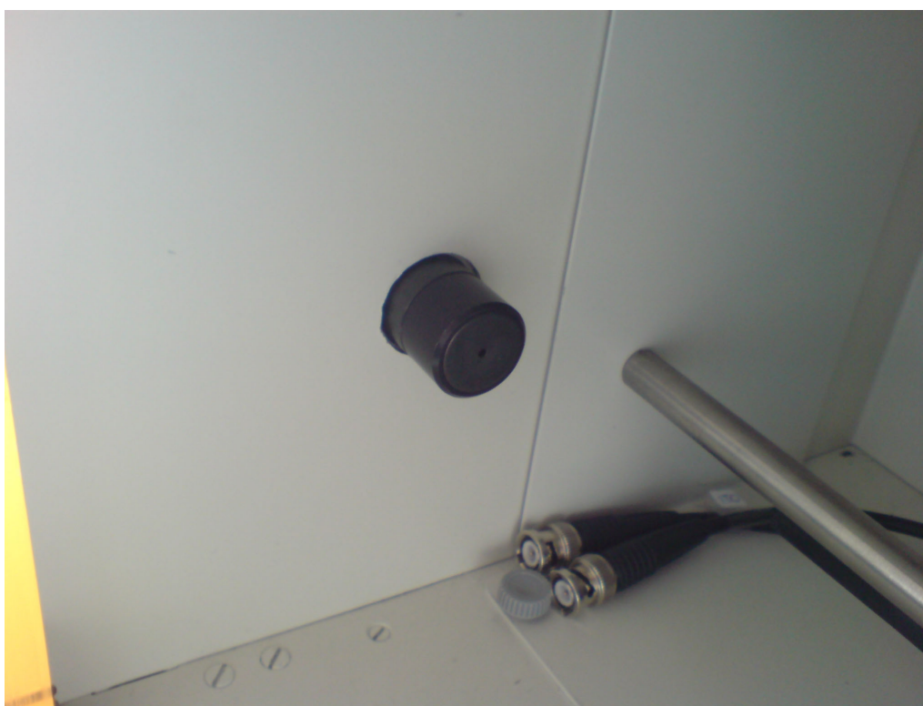
9 pav. Rentgeno vamzdžio diafragmos darbinė padėtis
