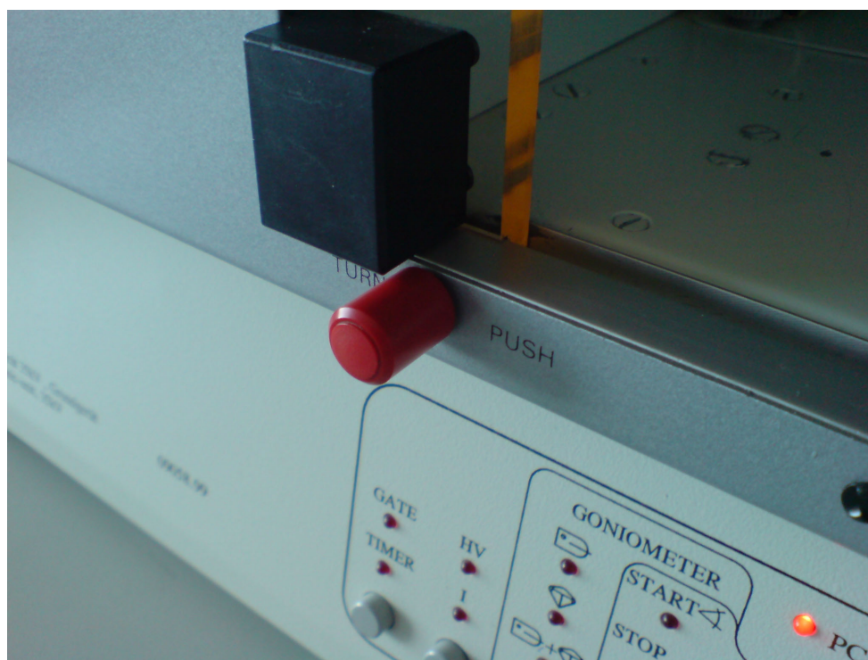
5 pav. Rentgeno aparato durelių fiksatorius (šioje nuotraukoje durelės yra atidarytos)
