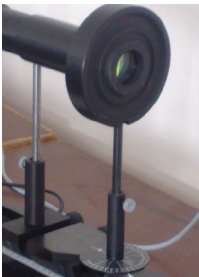
5 pav. Difrakcinės gardelės laikiklis (difrakcinė gardelė yra kitoje jo pusėje, kurią uždengia vamzdis)
