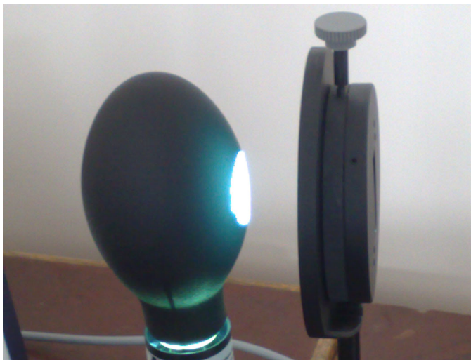
3 pav. Gyvsidabrio lempa ir ekranas su plyšiu
