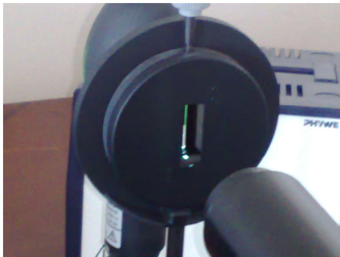
6 pav. Ekranas su plyšiu (viršuje matomas plyšio pločio reguliavimo varžtas)
