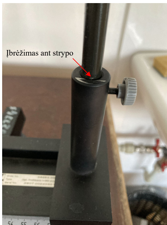
15 pav. Optinių sistemos komponentų (lempos, ekrano su plyšiu, lęšio, difrakcinės gardelės ir fotoelemento) padėtis turi būti tokia, kad įbrėžimas, kuris yra ant atitinkamo strypo, būtų ties laikiklio viršutiniu kraštu.
