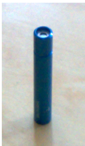
2 pav. ^{90}\text{Sr} radioaktyvusis šaltinis. Kairiojoje nuotraukoje radioaktyvioji medžiaga yra viršuje
