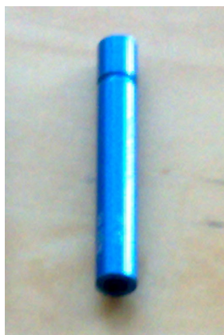
2 pav. ^{90}\text{Sr} radioaktyvusis šaltinis. Kairiojoje nuotraukoje radioaktyvioji medžiaga yra viršuje
