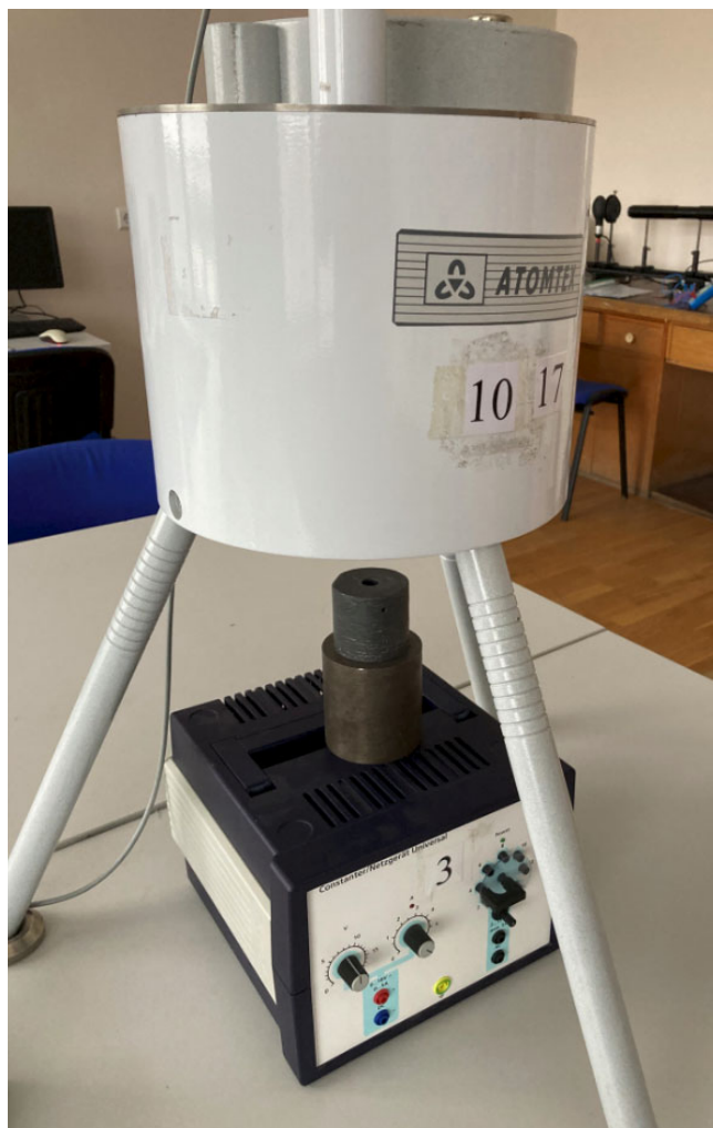
8 pav. ^{60}\text{Co} bandinys turi būti uždėtas ant pakyls, siekiant jį priartinti prie detektoriaus (nes to bandinio aktyvumas yra palyginti mažas). Šioje nuotraukoje pakyls vaidmenį atlieka laboratorinio darbo Nr. 3 maitinimo blokas.
