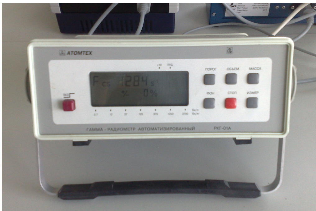
5 pav. Radiometro RKG-01A valdymo blokas (užrašas „0 %“ reiškia, kad santykinė paklaida mažesnė už 0,5 %)
