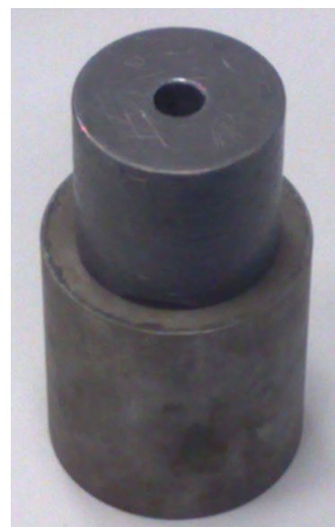
11 pav. ^{60}\text{Co} bandinio laikiklis, ant kurio uždėtas kolimatorius
