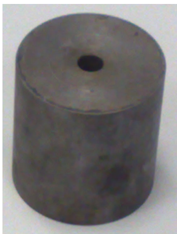
9 pav. ^{60}\text{Co} bandinio laikiklis (jis pagamintas iš plieno)
