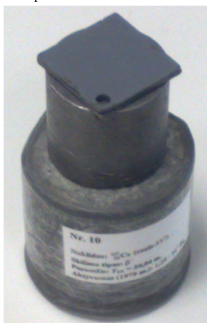
7 pav. ^{137}\text{Cs} konteineris, ant kurio uždėtas kolimatorius ir švino plokštelės (sugėrikliai)
