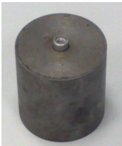
10 pav. Į plieninį laikiklį įdėtas ^{60}\text{Co} bandinys (yra matomas iš laikiklio išlindęs šaltinio galas, kuriame yra radioaktyvioji medžiaga)
