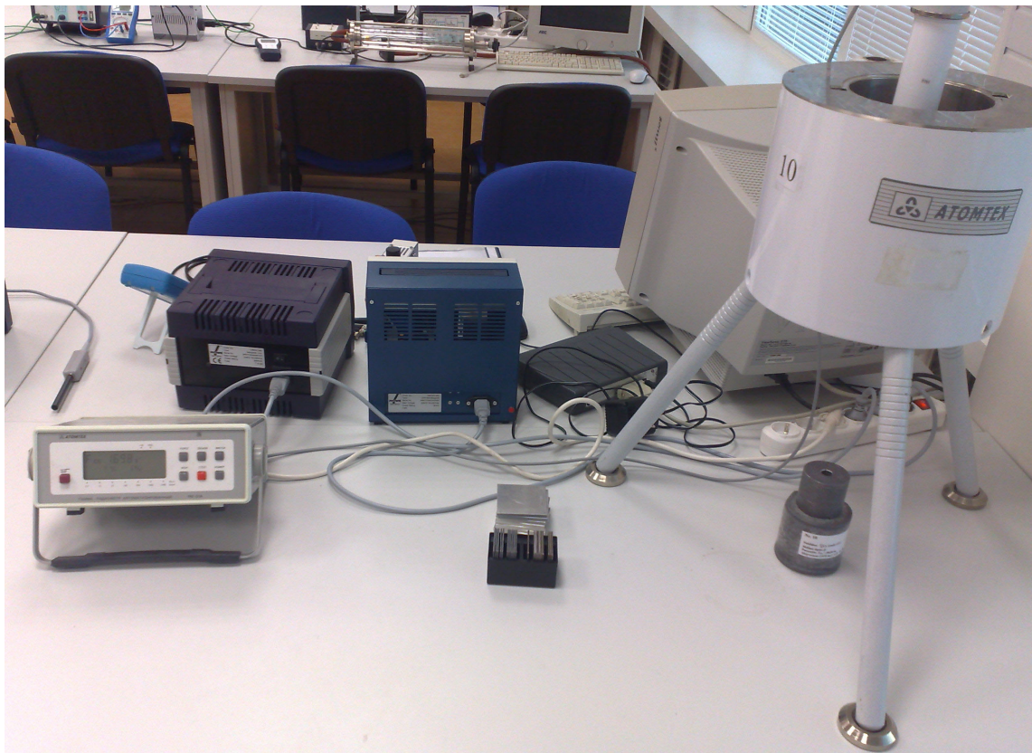
14 pav. Matavimo įrangos bendras vaizdas. Kairėje matomas gama radiometro RKG-01A valdymo blokas, dešinėje yra blyksimojo detektoriaus gaubtas (skirtas aplinkos fono įtakai sumažinti), į kurį įdėtas detektorius. Po detektoriumi ant stalo padėtas švino konteineris su vienu iš dviejų tiriamųjų šaltinių ( \text{Cs-137} ). Ant konteinerio uždėtas kolimatorius. Viduryje matoma dėžutė su 1 mm ir 2 mm storio švino ir geležies plokštelėmis, už jos – aštuonios 5 mm storio aliuminio plokštelės
