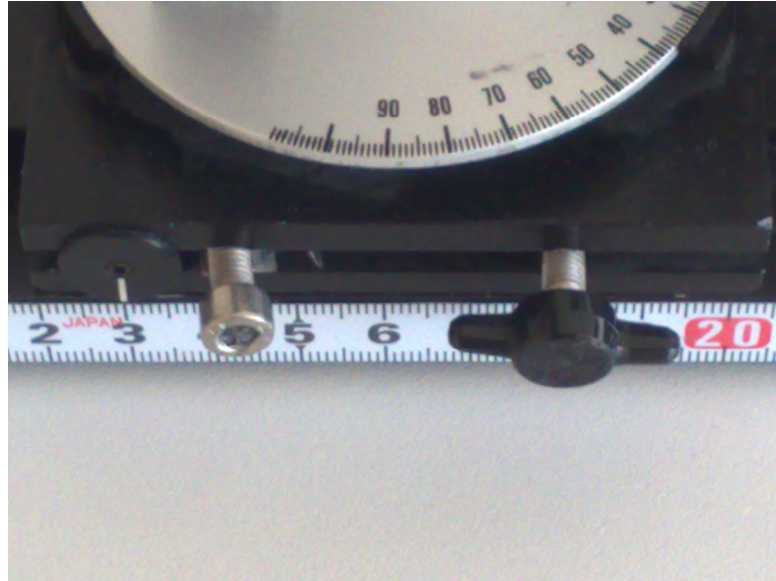
13 pav. Šaltinio stovo tvirtinimo varžtai. Jie turi būti atlaisvinti viso darbo metu
