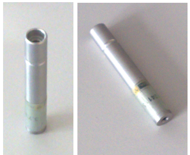
2 pav. Atviro Am-241 šaltinio nuotraukos. Kairiojoje nuotraukoje radioaktyvioji medžiaga yra viršuje
