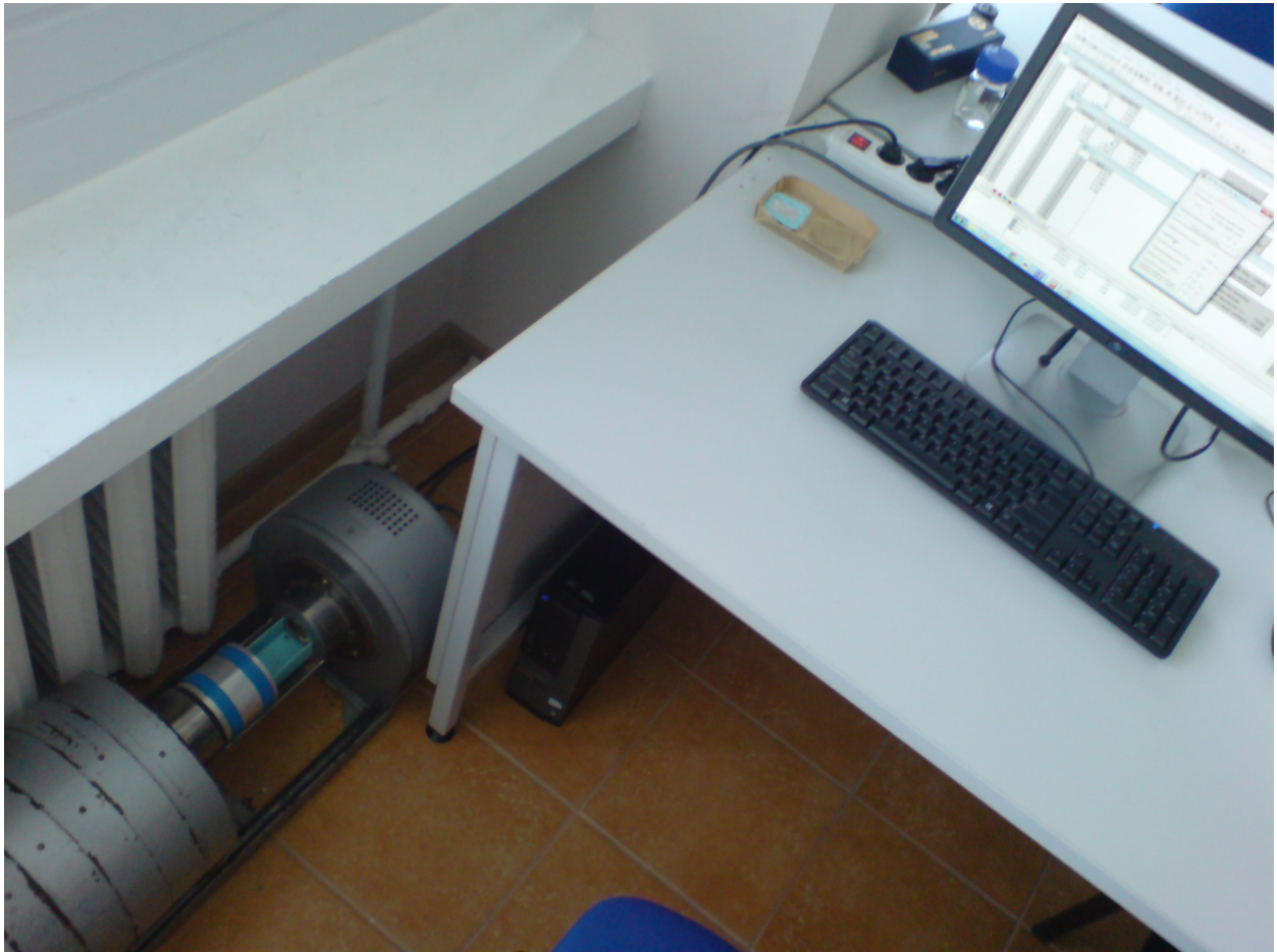
5 pav. Beta dalelių sugerties tyrimo įrangos bendras vaizdas. Detektoriaus blokas (įrenginys UMF) yra ant grindų šalia stalo. Prieš detektorių padėtas aliuminio konteineris su radioaktyviuoju bandiniu. Ant stalo yra matomi dėžutė su aliuminio ir organinio stiklo plokštelėmis bei monitorius, kuriame atvaizduoti valdymo programos pagrindinis langas bei programos „Origin“ lentelės su matavimo duomenimis
