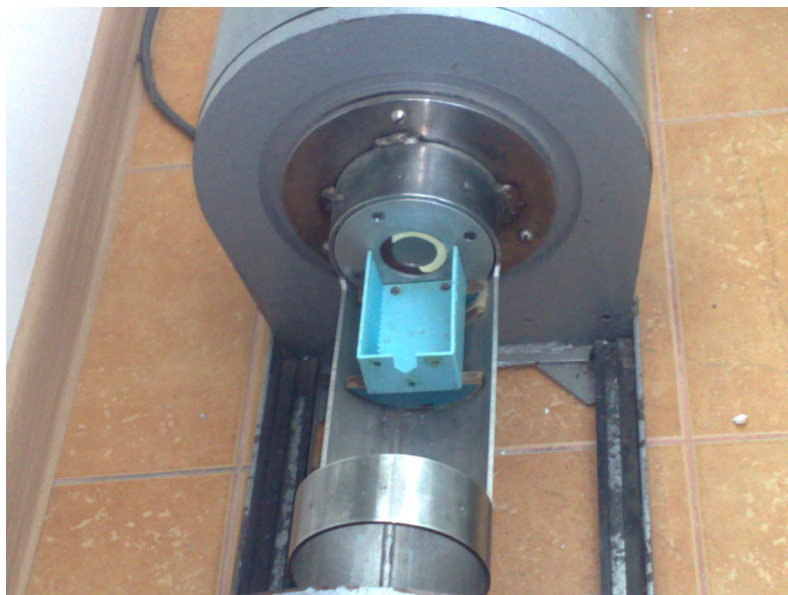
11 pav. Geigerio ir Miulerio detektoriaus langelis ir prieš jį esantis plokštelių laikiklis
