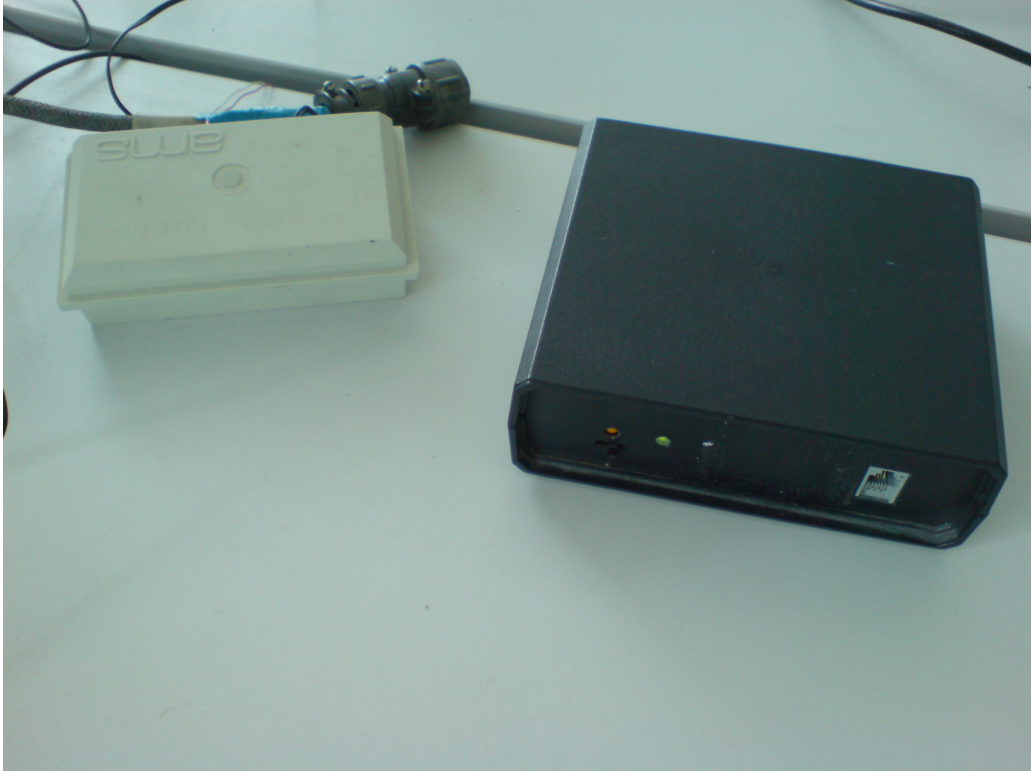
6 pav. Emiterinis kartotuvas (kairėje) ir impulsų skaičiavimo įrenginys su mikrokontroleriu (dešinėje)
