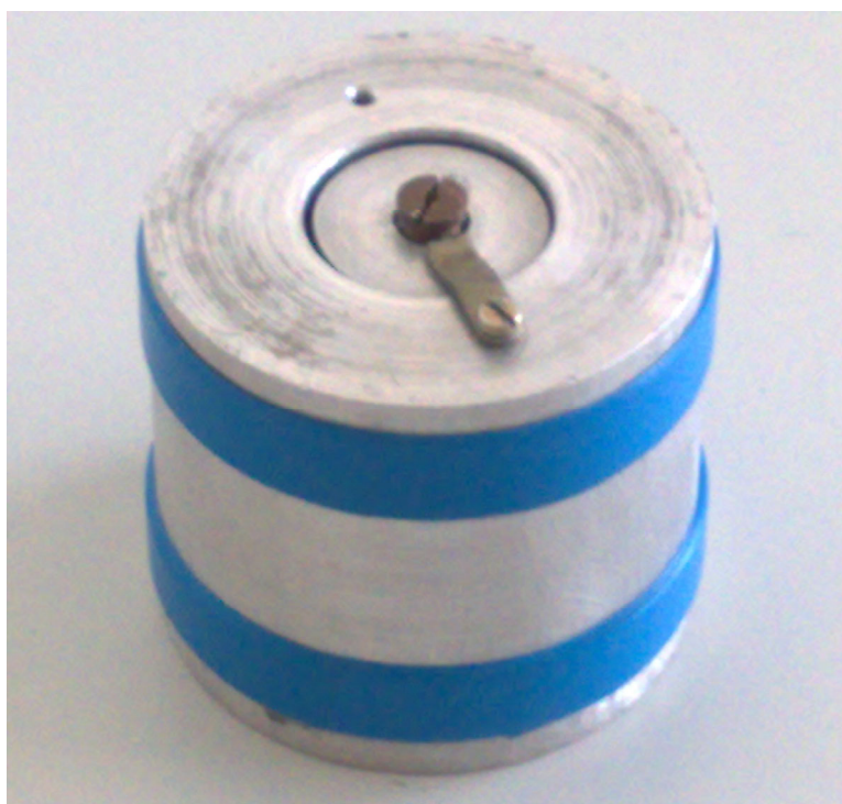
12 pav. Aliuminio konteineris, kurio viduje yra beta radioaktyvus Sr-90 bandinys. Spinduliuotė išeina pro mažą angą, kuri yra viršuje (ta anga neturi specialaus dangčio ir yra visą laiką atidengta)
