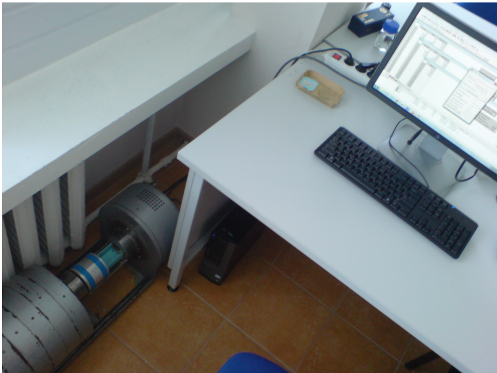
19 pav. Beta dalelių sugerties tyrimo įrangos bendras vaizdas. Detektoriaus blokas (įrenginys UMF) yra ant grindų šalia stalo. Prieš detektorius padėtas aliuminio konteineris su radioaktyviuoju bandiniu. Ant stalo yra matomi dėžutė su aliuminio ir organinio stiklo plokštelėmis bei monitorius, kuriame atvaizduoti valdymo programos pagrindinis langas bei programos „Origin“ lentelės su matavimo duomenimis
