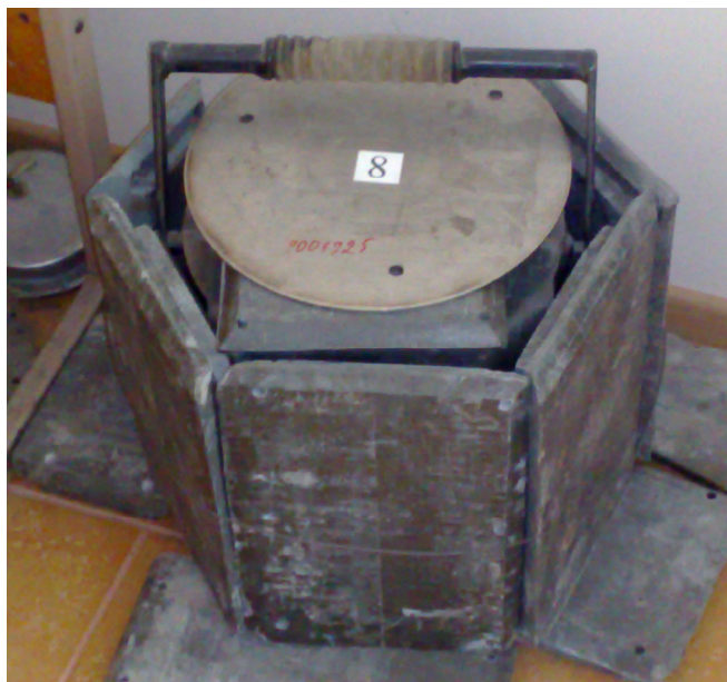
15 pav. Neutronų šaltinio konteineris (neutronų šaltinis yra jo dugne). Konteinerį supa švino plytos, kurios sumažina gama spinduliuotės intensyvumą aplinkoje
