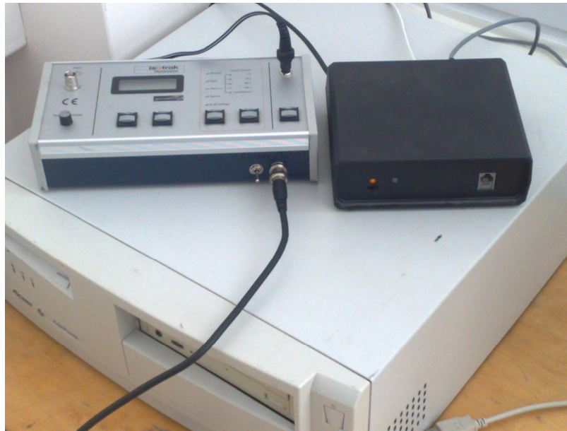
14 pav. Matavimo įrangos fragmentas. Ant kompiuterio sisteminio bloko matomi du įrenginiai – detektoriaus maitinimo blokas ir impulsų skaičiavimo įrenginys (dešinėje). [Pats detektorius čia neparodytas, nes, kai buvo rašomas šis aprašas, detektoriaus blokas buvo remontuojamas.]
