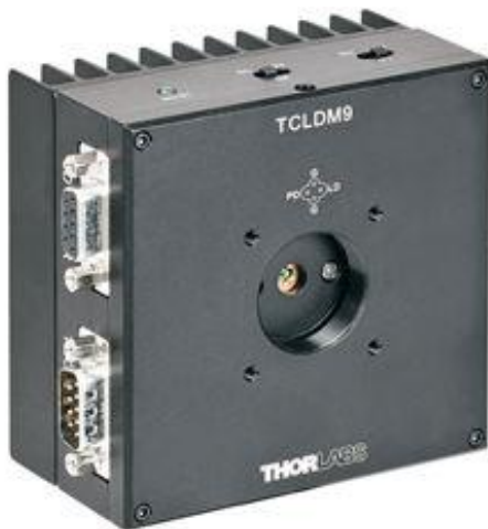
2 pav. Lazerinio diodo maitinimo ir šaldymo blokas
