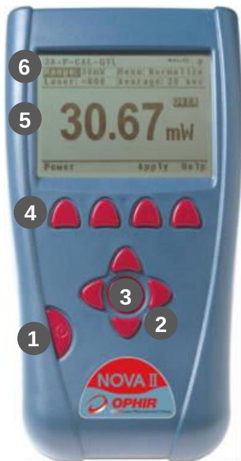
4 pav. Optinės galios matuoklio displėjus Ophir Nova II
