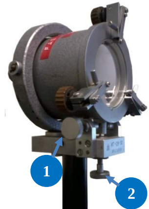
6 pav. Fabri-Pero interferometras. 1 ir 2 – derinimo varžtai.
