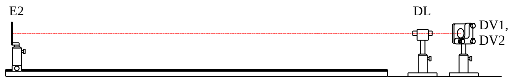
12 pav. Derinimo lazerio spindulio krypties derinimas
