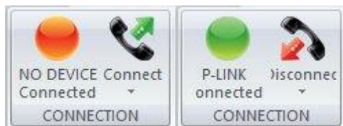
5 pav. Prijungimo skydelis, kai optinės galios matuoklis neprijungtas (kairėje) ir prijungtas (dešinėje).
