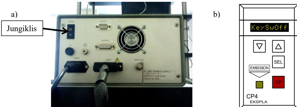
4 pav. Lazerio: a) maitinimo bloko galinė dalis; b) valdymo pultas.
