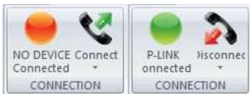
6 pav. Prijungimo skydelis, kai optinės galios matuoklis neprijungtas (kairėje) ir prijungtas (dešinėje).
