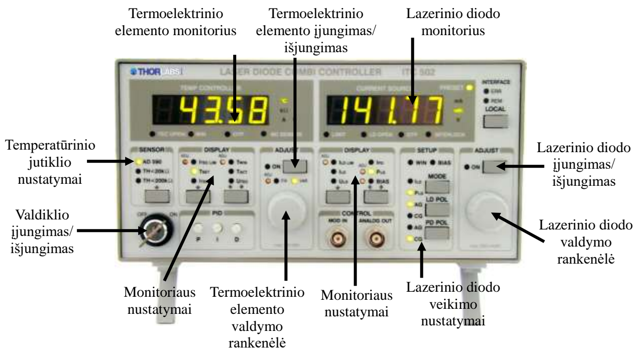
3 pav. Lazerinio diodo maitinimo ir šaldymo bloko valdiklis
